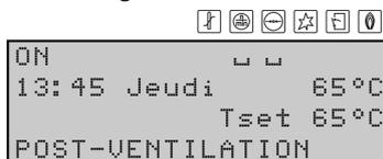
8. Après la post-purge, le ventilateur s'arrête et le pressostat s'ouvre :
