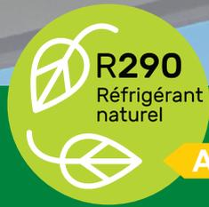
L'Enevator Air Altus a pour fluide frigorigène le R290. Le GWP de ce réfrigérant est de 3 seulement. Ainsi, la pompe à chaleur satisfait aux réglementations à venir dans le domaine de l'environnement et du changement climatique. D'autre part, ce réfrigérant permet d'obtenir des températures particulièrement élevées, ce qui rend le post-chauffage superflu dans la plupart des cas.
