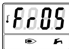
Pour éviter que l'eau présente dans le chauffe-eau ne gèle, la protection antigel est activée lorsque le chauffe-eau est en **mode ARRÊT**. La protection antigel commence lorsque la température de l'eau descend en dessous de 5°C. L'écran affiche les caractères *Fr*, suivis de la température réelle. L'appareil chauffe l'eau jusqu'à 20°C et revient ensuite en **mode ARRÊT**.
