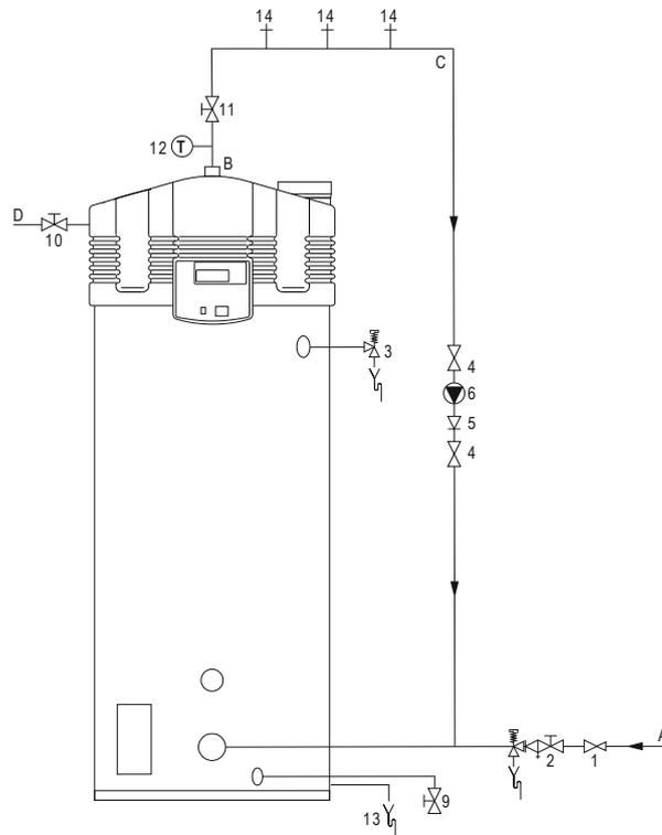
1. Válvula de redução de pressão (obrigatória, se a pressão da água da rede de distribuição for demasiado alta)
